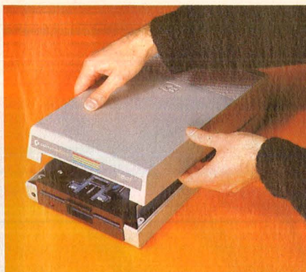
Floppy umdrehen und den Deckel nach hinten abheben
